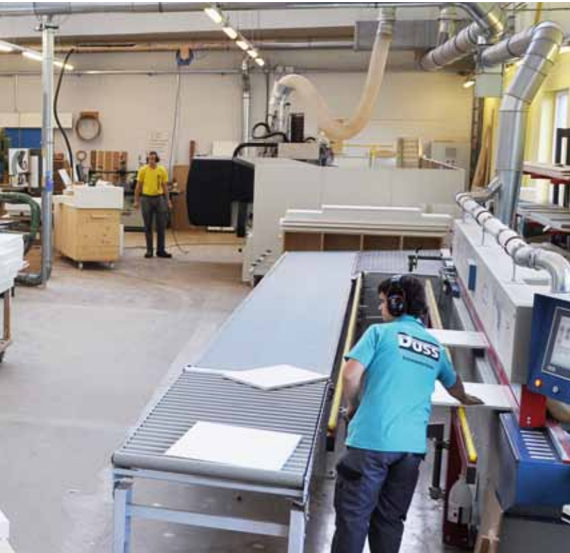
Der Maschinenraum mit neuer Kantenleimmaschine, Bearbeitungszentrum (BAZ) und Breitbandschleifmaschine. Die schwarze Fläche am BAZ ist der «Bumper», dafür braucht es keine Trittmatten.
